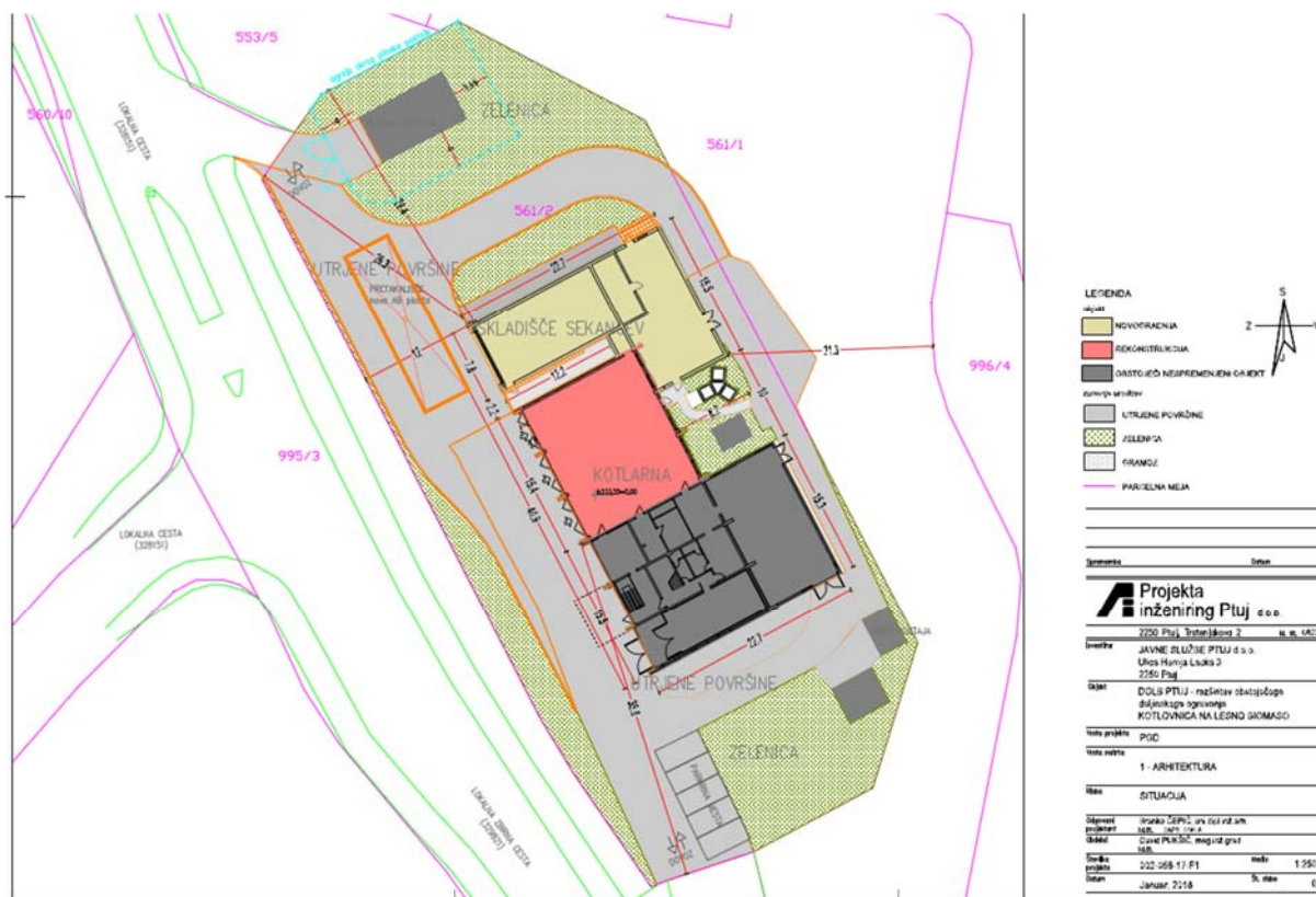
Slika 7: Načrtovano stanje kotlovnice po investiciji
